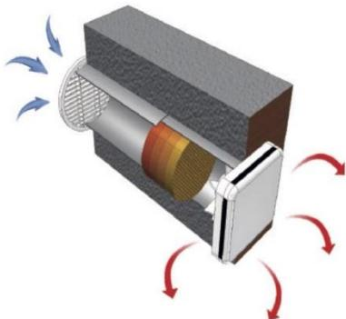
**La macchina immette l'aria fresca in ambiente dall'esterno. Lo scambiatore cede il calore riscaldando l'aria immessa.**
